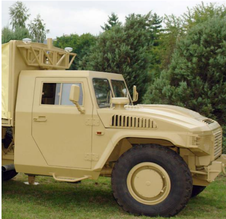
Slika 8 – Letva sa GPS antenama na jednom oglednom vozilu Figure 8 – Rod with two GPS antennas on an experimental vehicle
