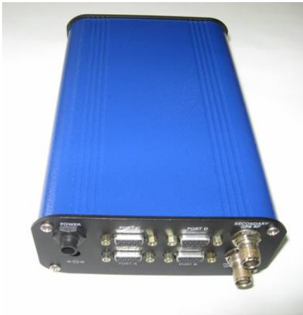
Slika 10 – Izgled jednog risivera za prijem i obradu podataka Figure 10 – A receiver for data acquisition and processing
