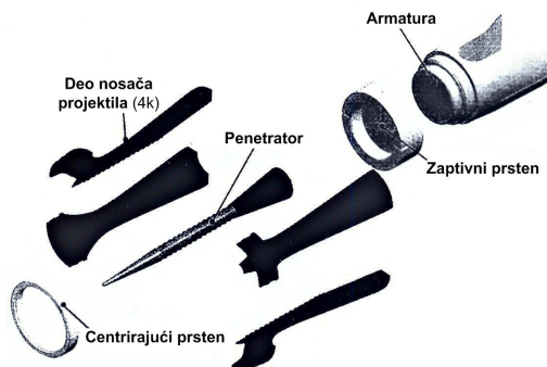
Slika 12 – Delovi sklopa KE projektila za EM top
