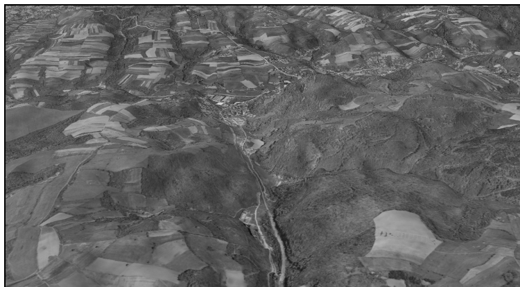
Slika 7 – Vizuelizacija DMT preklapljenog ortofoto-snimkom (ArcGis 9.2)
