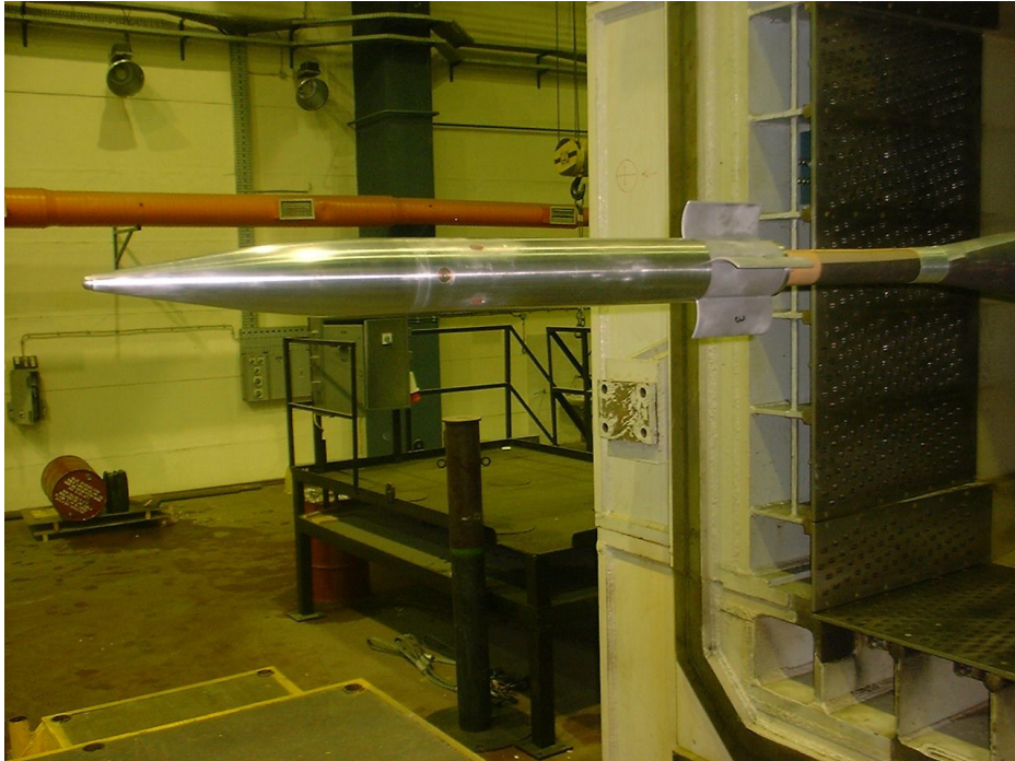
Sl. 2 – Model 1 sa olučastim krilima u radnom delu aerotunela T-38
