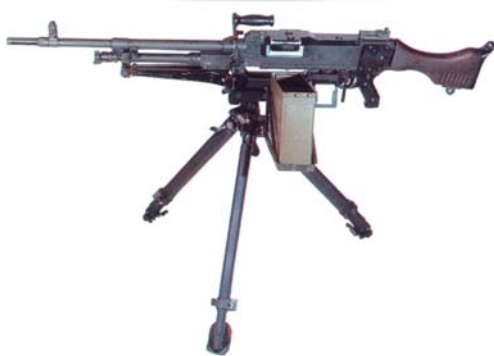
Novo aluminijumsko postolje sa mitraljezom 7,62 mm MAG 58
