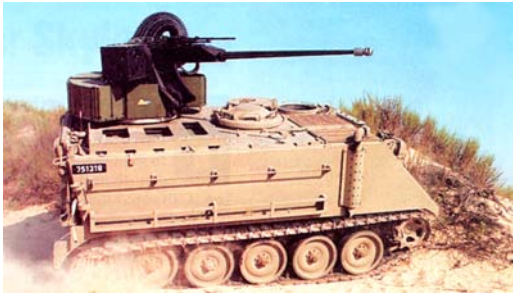
Kupola bez posade sa topom 30 mm na oklopnom transporteru M113
