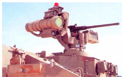
Sistem Thor s laserom velike energije i mitraljezom 12,7 mm na stabilizovanom daljinski upravljanoj postolju
