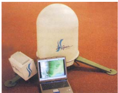
Prijemnik TacSAS s pripadajućom elektronskom jedinicom i laptopom za satelit NOAA
