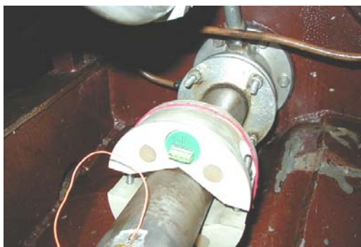
Sl. 2 – Napajanje mernog mosta i beskontaktni prenos signala
