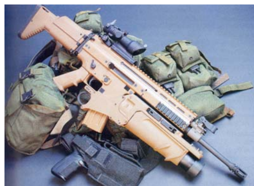
Karabin Mk 16 SCAR-L sa ugrađenim bacačem granata 40 mm i ostalom opremom specijalca
