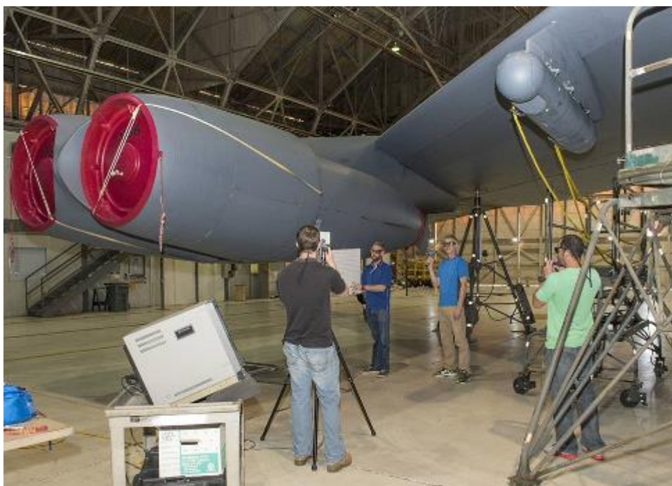
Подвесни нишански уређај LITENING испод крила бомбардера B-52H
