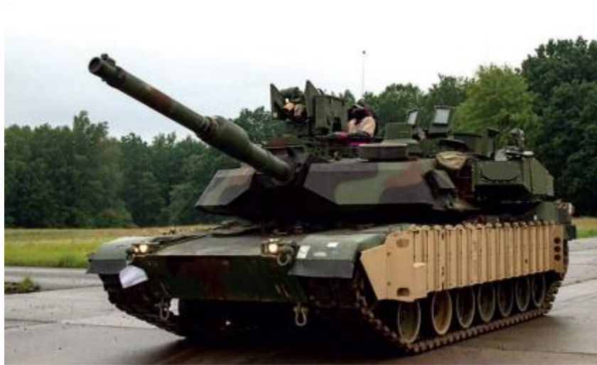
M1A2 SEPv2 опремљен активним системом заштите Trophy-HV
