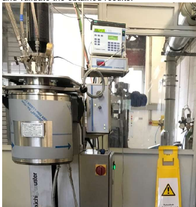
Figure 2 – Autoclave for the carbonation process Рис. 2 – Автоклав для процесса карбонизации Слика 2 – Аутоклав за везивање угљен-диоксида
