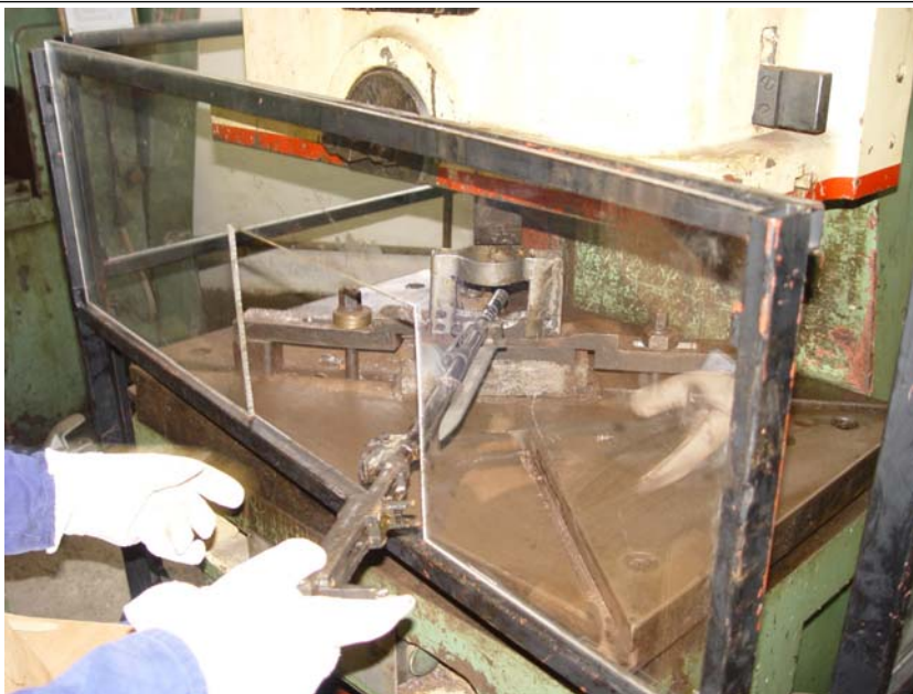
Sl. 6 – Jedan od načina zaštite u toku uništavanja naoružanja na hidropneumatskim presama
