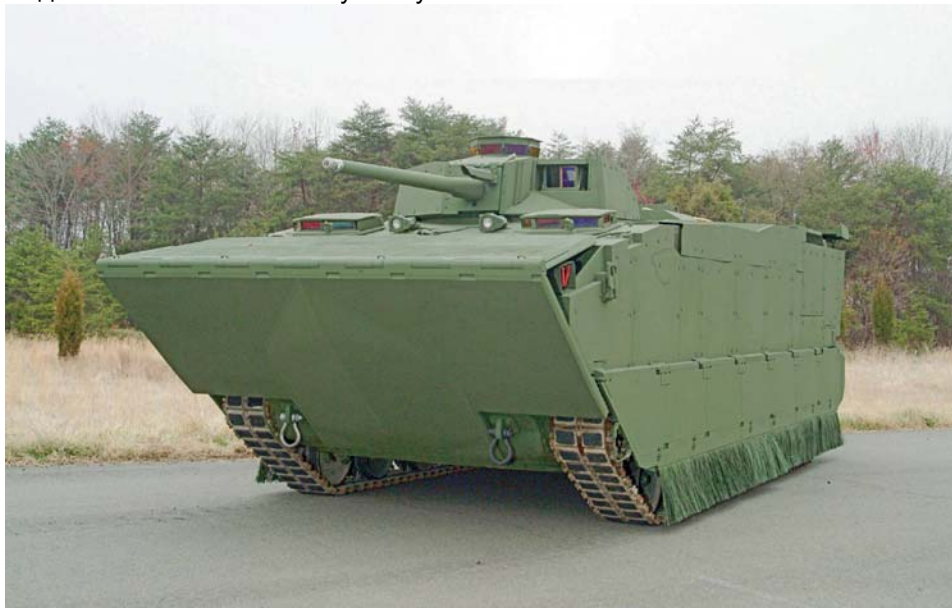
Прототип возила EFV наоружаног аутоматским топом Bushmaster Mk44 30 мм
