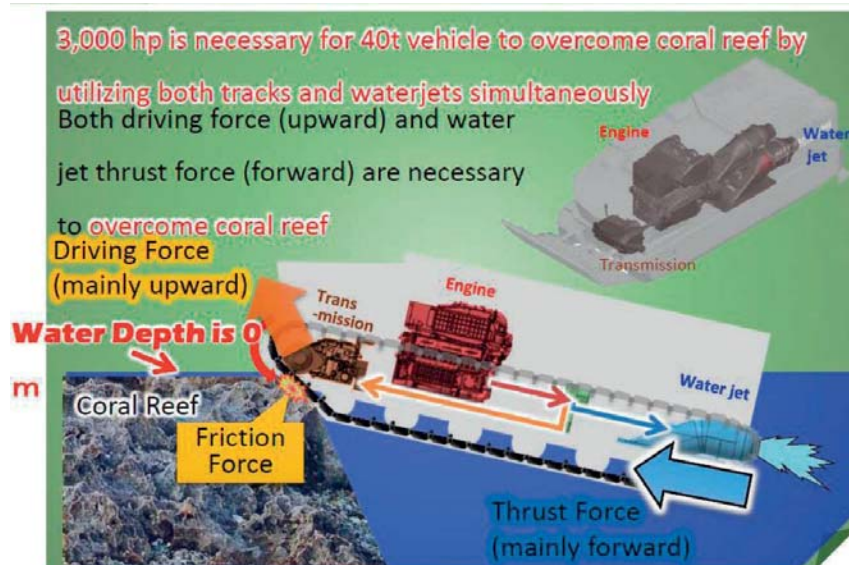
Приказ истовремене употребе пумпи са воденим млазом и гусеница за савладавање коралних гребена
