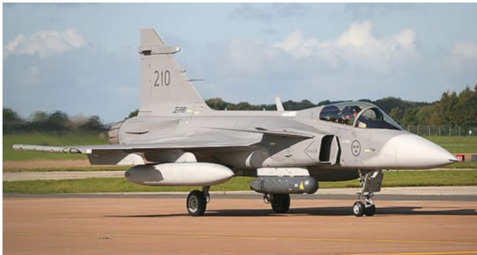
Грипен опремљен подвесним нишанским уређајем Litening III
