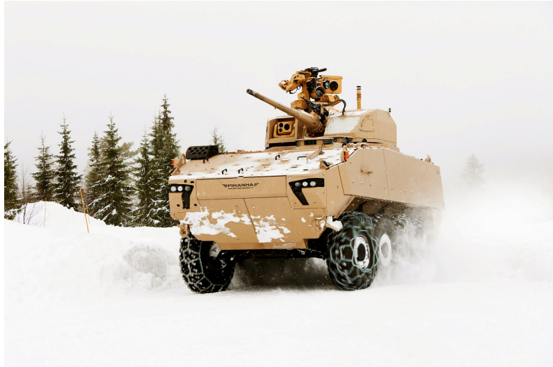
Piranha 5 опремљена куполом са топом 30 mm МК44 Bushmaster компаније Orbital ATK
