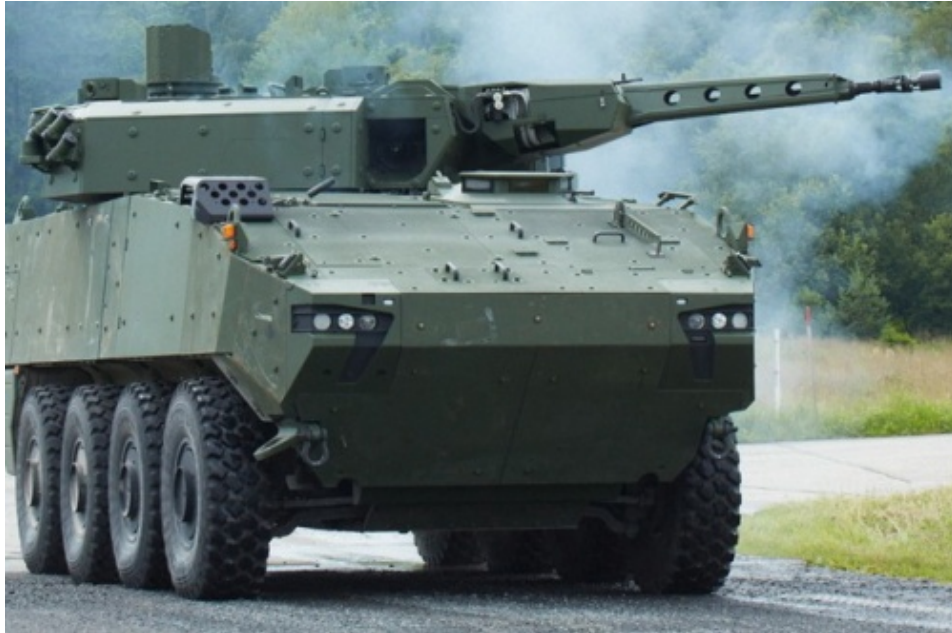
Возило наоружано куполом Lance, опремљено топом Mauser MK30
