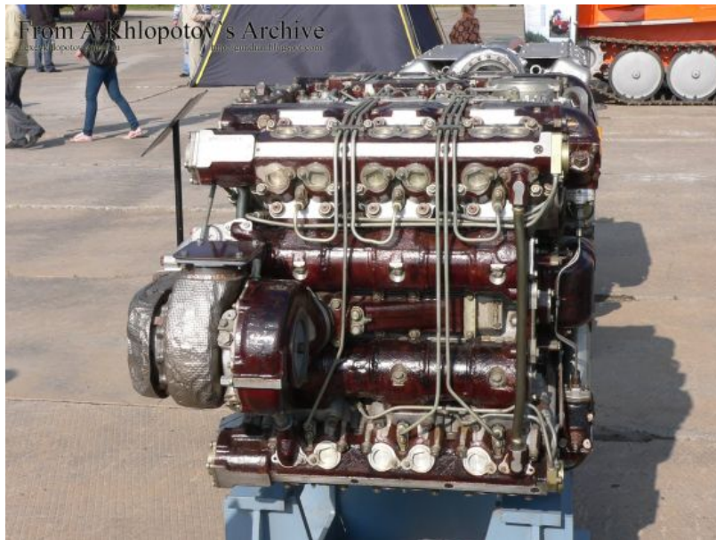
Клипни четворотактни 12-цилиндрични турбо-дизел мотор 85-3А тенка „армата”
