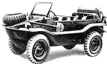
Slika 2 – „Folkswagenovo“ ploveće vozilo Figure 2 – VW-Schwimmwagen amphibious vehicle
