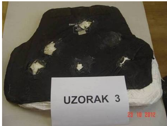
Slika 8 – Uzorak 3 nakon sprovedenih laboratorijskih ispitivanja PICTURE 8 – Sample 3 after conducting laboratory tests
