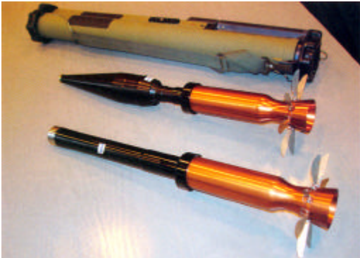
Lako protivoklopno oružje kompanije Nammo (odozgo prema dole): lanser M72 EC LAW; projektil M72 EC LAW i M72 ASM-RC
