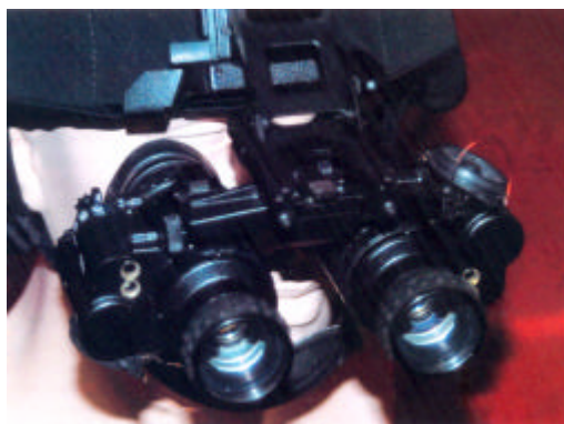
Binokularni dvogled za noćno osmatranje MU-3
