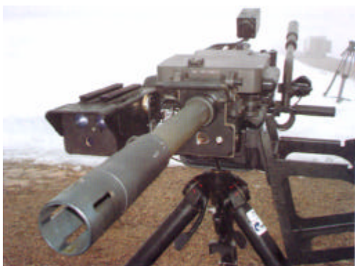
Nišanski sistem Vingmate na automatskom bacač granata Heckler & Koch GMG
