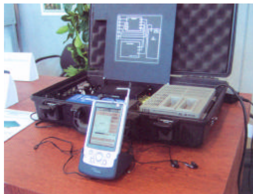
Komplet RK-1025 s rucnim displejom operatora izradenim na bazi Fujitsu-Siemens PDA
