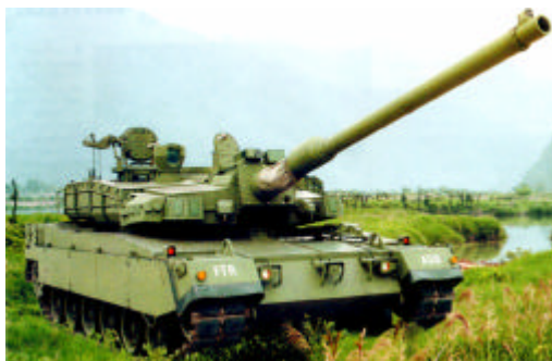
Tenk K2 naoružan glatkocevnim topom 120 mm L55
