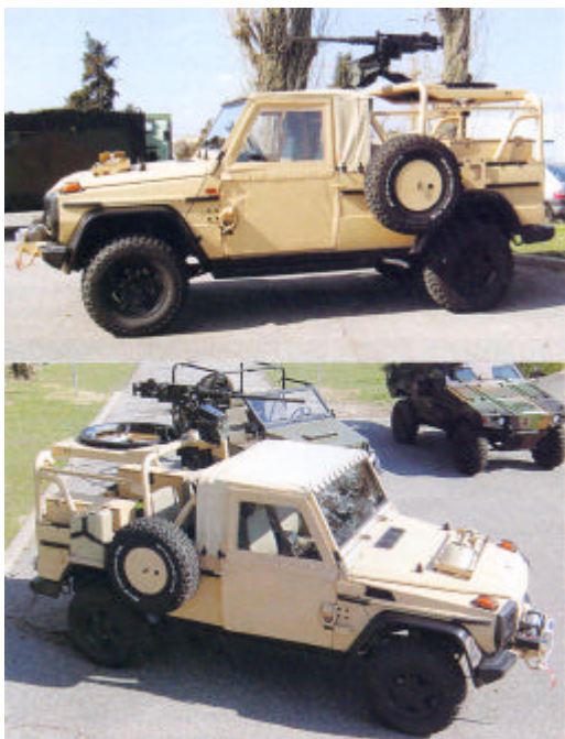
Specijalno patrolno vozilo Panhard SPV 4×4
