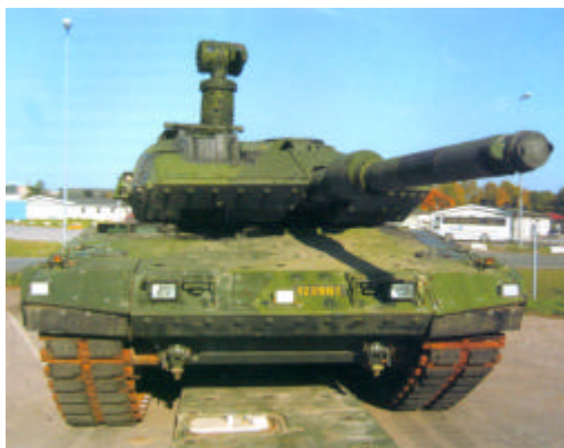
Švedski tenk Leopard 2A5 sa ugrađenom kombinovanom daljinski upravljanom oružnom stanicom i komandirskim nišanom
